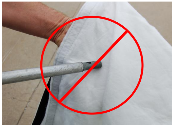
LICHT REINIGEN ALLEEN MET PERSLUCHT, VAN BUITEN NAAR BINNEN. HOUD DE ZUIGMOND OP 15-30 CM VAN DE STOF
